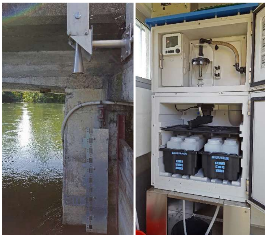
Abbildung 8: Hydrometrische Mess- und Probenahmestation Frauental an der Lorze. Foto links: Pegelmessung mit Radar und Ansaugschlauch des Wasserprobennehmers. Foto rechts: Dosiereinheit für Wasserproben integriert in Kabinenschrank. Quelle Fotos: AFU Zug
