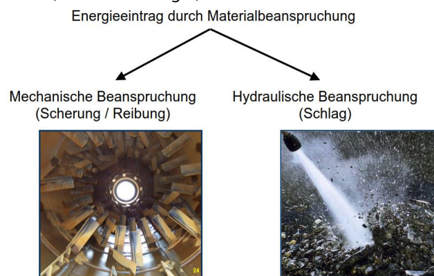
Abbildung 2 Formen des Energieeintrags beim Waschprozess [12]
