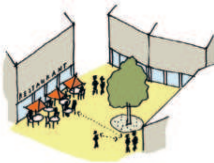
⊕ Bei der Dimensionierung und Gestaltung von Stadträumen sind Geh-, Seh- und Hördistanzen zu berücksichtigen. Abbildung 11
