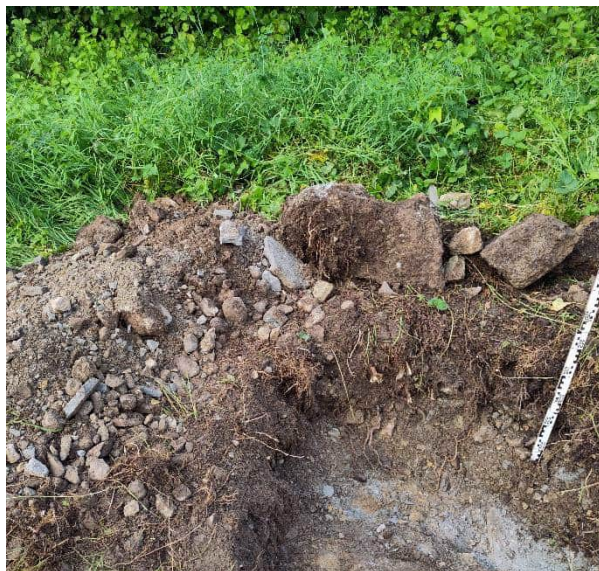
Tipologia di materiale trincea 3: GW-GM con blocchi in roccia
