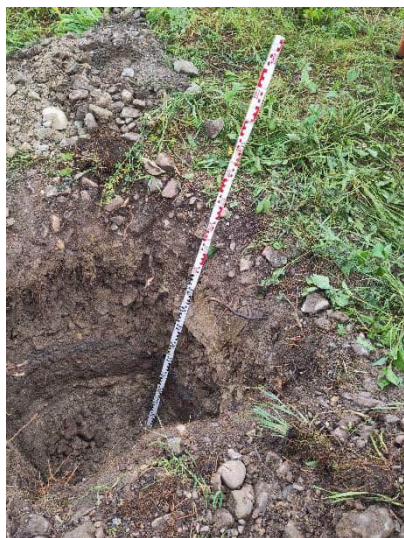
Vista della trincea 1 per la prova di infiltrazione
