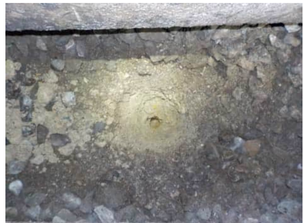
Bild 42: W9, km 24.815, Hauptstrang: Blick in den Aufschluss, der Unterbau besteht aus leicht siltigem Kies mit Sand (Bodengruppe GW-GM)
