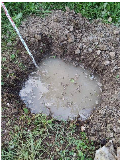
Posizione della trincea 4 per la prova di infiltrazione, riempimento 0.4 m 3 di acqua
