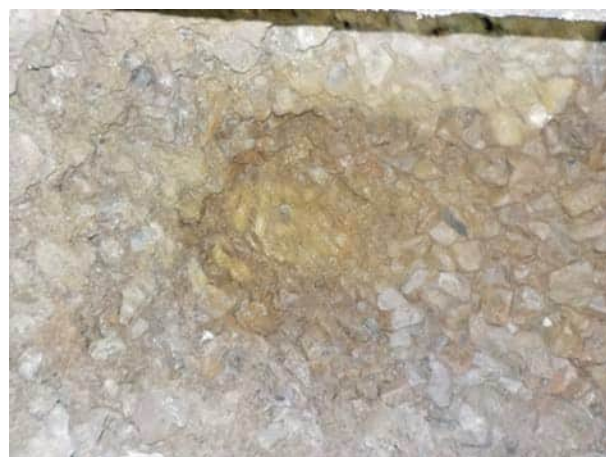
Bild 28: Gleis 21-425, km 23.920: Blick in den Aufschluss, das Schotterbett reicht bis in eine Tiefe von 1 m unter SwOK, dann folgt leicht siltyer Kies/Schotter mit Sand (Bodengruppe GP-GM)
